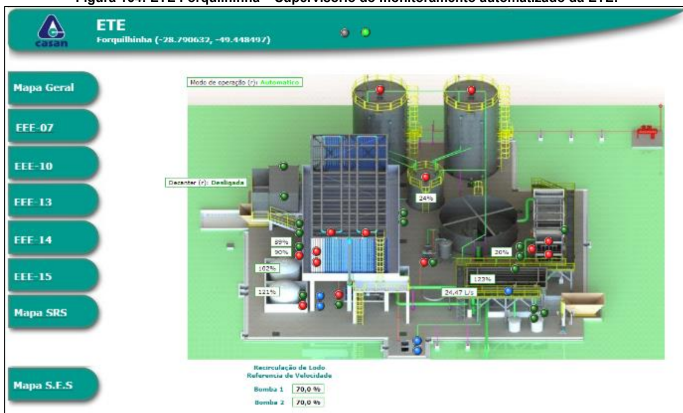
Figura 164: ETE Forquilha – Supervisorio do monitoramento automatizado da ETE.
